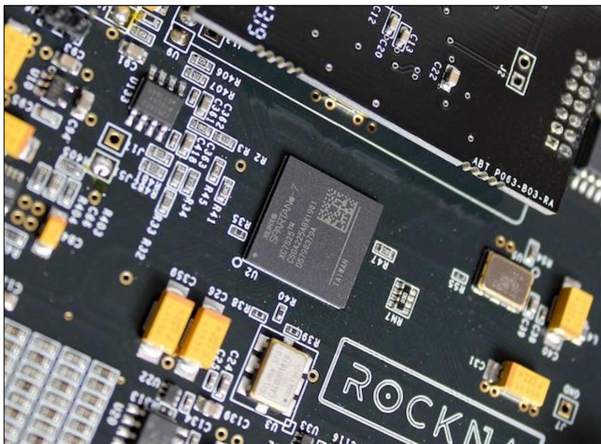
In der Bildmitte: Die Steuerzentrale des Rockna Wavelight PRE/DAC, der Xilinx-Spartan-7-FPGA
