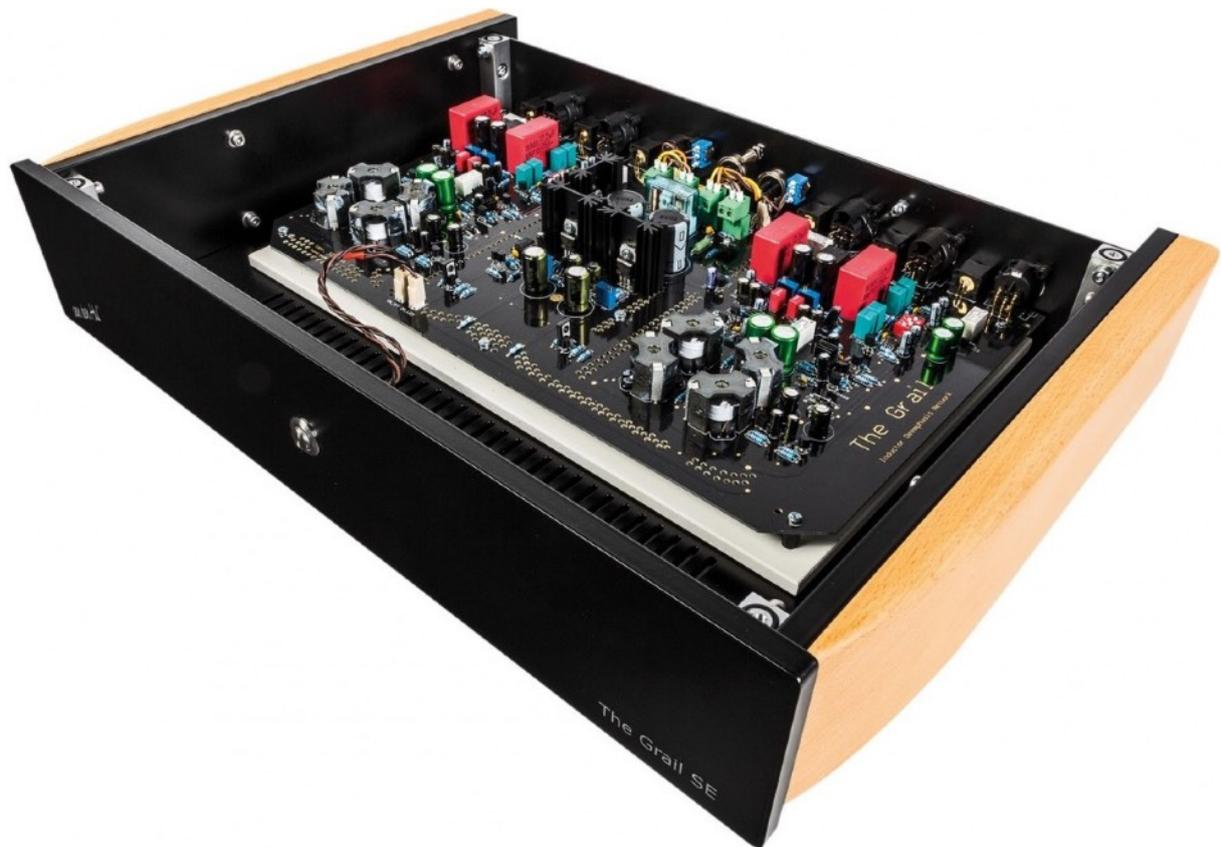
*La carte audio est découplée du boîtier et repose sur sa propre platine absorbante*
