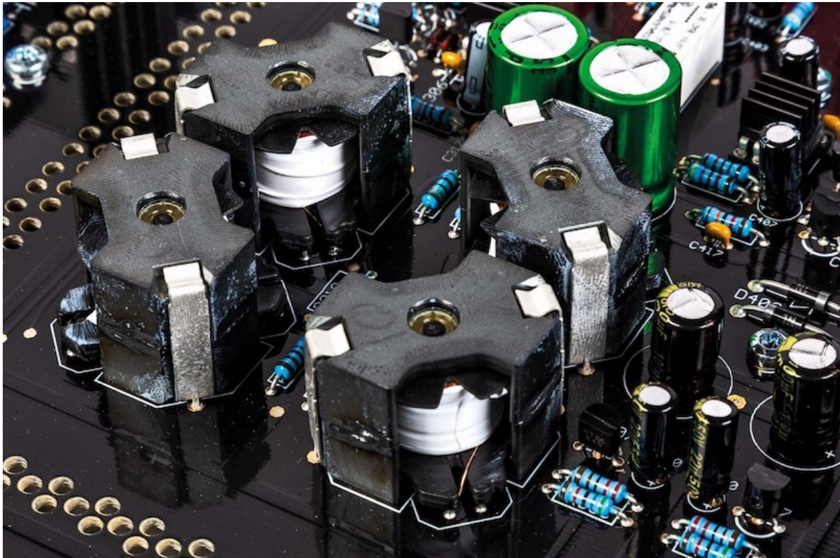
Das Entzerrernetzwerk arbeitet mit extrem eng tolerierten Drosselspuelen
