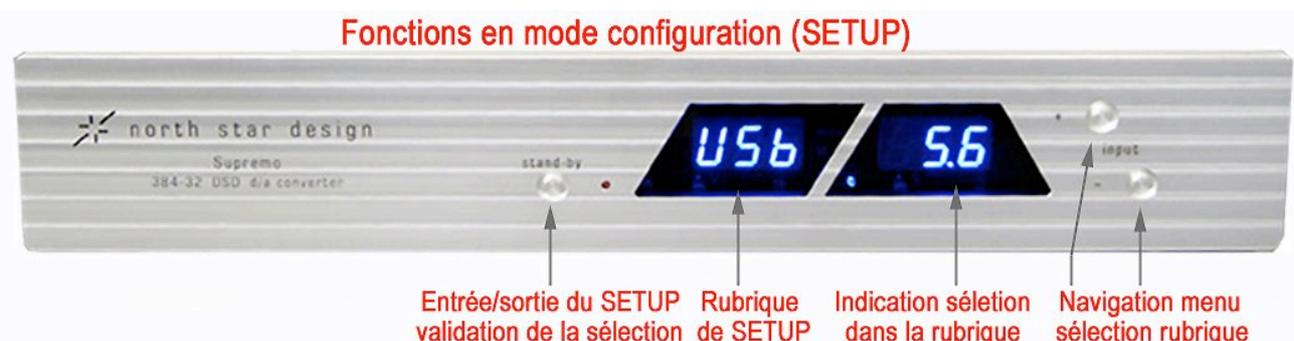
La navigation dans ce menu s'effectue par les touches « + » ou « - ». L'afficheur indique à gauche la rubrique du menu SETUP et à droite la sélection proposée qui clignote jusqu'à sa validation par appui sur la touche Stand By.
