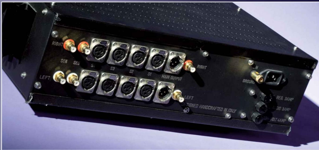
On notera les trois fusibles à droite dont deux distincts pour la haute tension et le chauffage des filaments.
