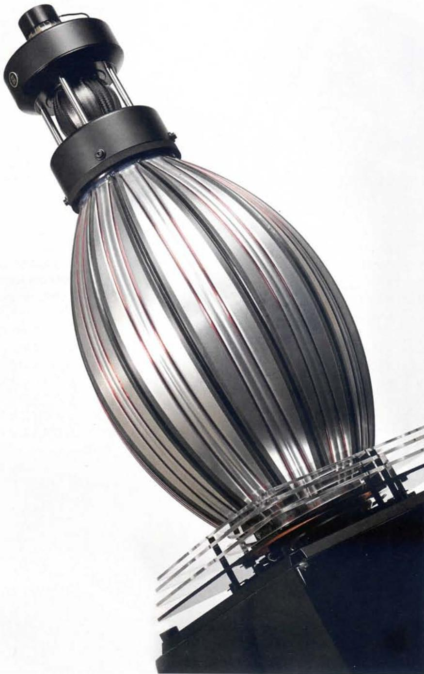
une bobine dans un champ magnétique située en bas qui les pousse selon la modulation positive, et les tire au retour, à l'image d'une sphère pulsant sur 360 degrés. Des ondes sonores indirectes sont également créées, d'une importance cruciale, qui remplissent la pièce comme le fait un instrument, évitant la directivité excessive inhérente aux haut-parleurs conventionnels rayonnant par l'avant.
