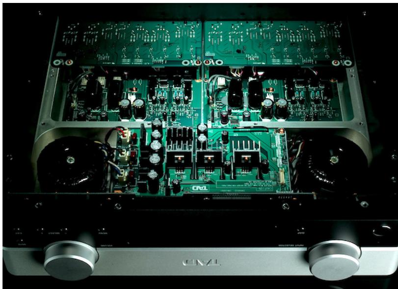
Pour éviter toute perturbation par les vibrations, le châssis est usiné dans la masse à partir d'un bloc d'aluminium. Sur cette plate-forme massive, stable et mécaniquement reliée à la terre par trois pieds en fonte, sont fixés directement les composants ou les différents circuits.
