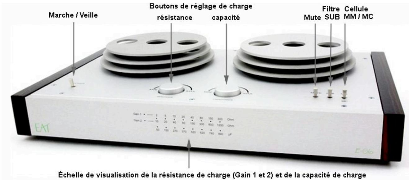
Échelle de visualisation de la résistance de charge (Gain 1 et 2) et de la capacité de charge
