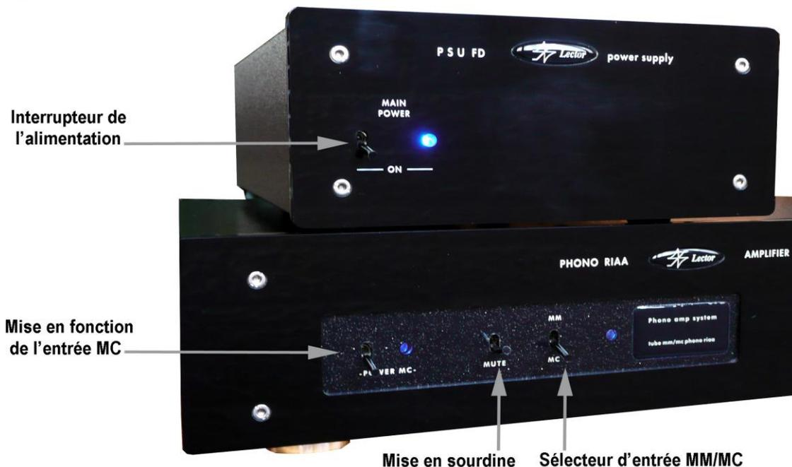
L'amplification d'une cellule MC nécessite d'actionner le commutateur « Power MC » mettant sous tension les circuits propres à cette entrée, indiquée par l'allumage du voyant situé à sa droite, ainsi que la choix de la position MC par le sélecteur d'entrée MM/MC.
