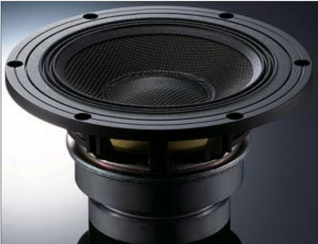
Le woofer de 16 cm utilise le nouveau diaphragme MACC Cône Composite Multicouche (Aramid) qui a une résistance accrue et une faible perte interne pour des caractéristiques de vibration idéales, ainsi qu'un circuit magnétique avec d'excellentes caractéristiques d'entraînement linéaire. La membrane utilise un tissu aramide et des matériaux non tissés qui sont formés séparément puis stratifiés pour obtenir des médiums et des basses riches et lisses sans coloration avec une excellente linéarité.
