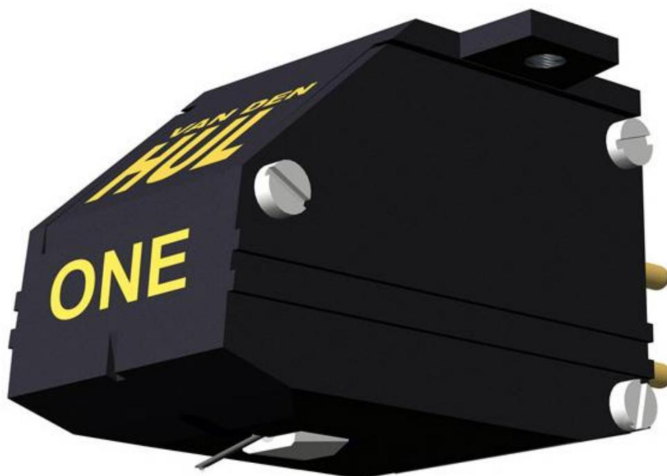
Une cellule à bobine mobile, faite sur commande ; version sélectionnée de MC-10 SPECIAL, avec 0,65 mV de tension de sortie. Le qualificatif "Spécial" de la référence indique des améliorations importantes par rapport à la version précédente : la cellule est équipée d'un pivot frontal plus épais et un petit aimant supplémentaire, tous deux augmentant ses possibilités de résolution et sa tension de sortie.
