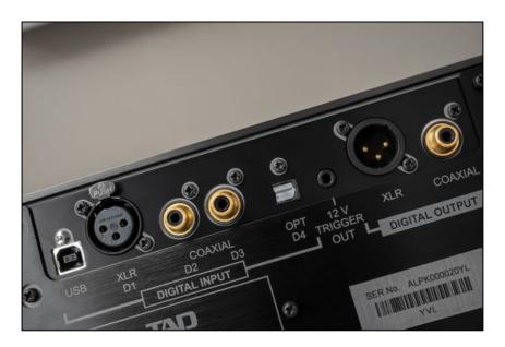
Auch eingangsseitig punktet der D1000TX mit seiner digitalen Anschlussvielfalt: Er bietet einen USB-Port für den Anschluss eines Laptops oder Computers, eine symmetrische AES3-Schnittstelle in Form einer XLR-Buchse sowie zwei koaxial-elektrische und einen optischen S/PDIF-Input. So kann der D1000TX auch als eigenständiger DAC genutzt werden.
