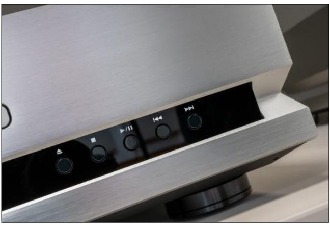
Das rechte Bedienfeld bietet die Taster für die Bedienung der CD-Funktionen – also Öffnen/Schließen, Stopp, Start/Pause sowie Tracksprung rück- und vorwärts.
