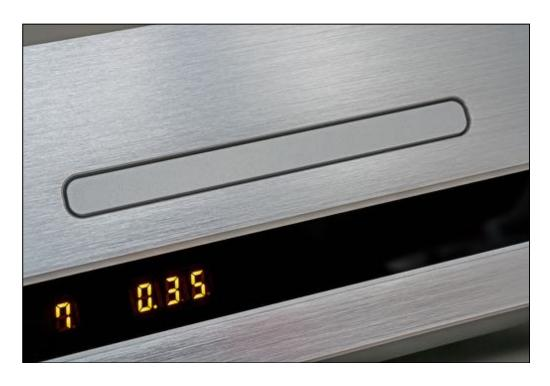
Unterhalb der zentralen CD-Schublade ist leicht versetzt das Display positioniert. Im CD-Betrieb zeigt es Tracknummer, abgelaufene Trackzeit, verbleibende Trackdauer und restliche CD-Spielzeit an. Im DAC-Mode zur Nutzung externer Zuspieler werden die Eingänge etwas kryptisch mit U2 für USB, D1 für XLR D2 und D3 für S/PDIF koaxialelektrisch sowie D4 für S/PDIF optisch ausgewiesen. Dazu informiert uns das Display über die PCM-Abtastrate beziehungsweise DSD-Qualität des aktuellen Tracks.
