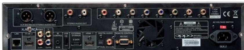
**La face arrière est identique à celle du lecteur Oppo BDP 95 d'origine, à l'exception du switch à gauche sous les sorties symétriques XLR permettant de choisir entre celles-ci et les sorties RCA marquées Stéréo Audio Out.**
