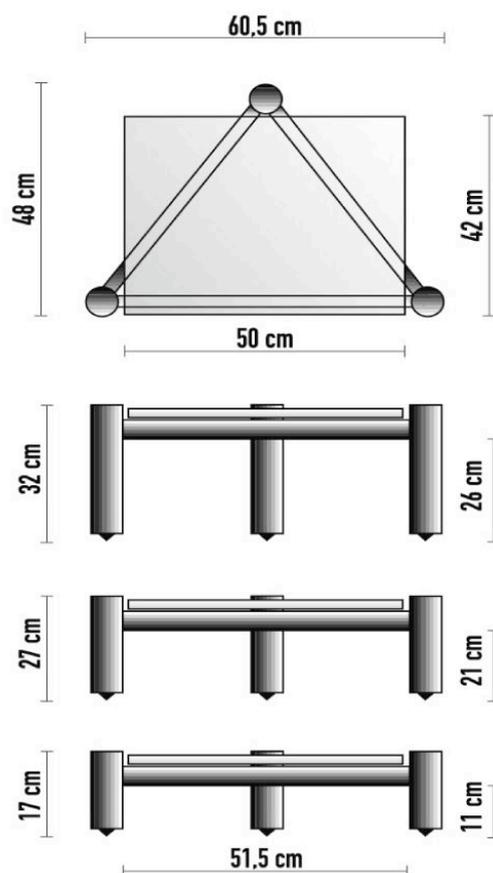
ISOshelf est un mobilier modulaire empilable destiné à l'audio. Chaque module est un tripode en acier soudé rempli de Fillin et d'une étagère de 2 épaisseurs de verre prenant en sandwich une couche de matériau transparent et amortissant. La structure disponible en trois hauteurs est recouverte d'une peinture plastique noire ou grise absorbante.
