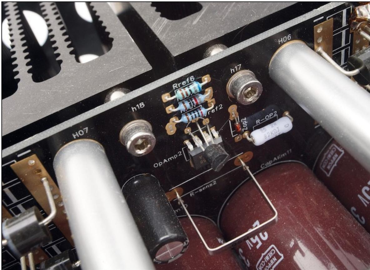
*In der Endstufe gibt's sogar einen integrierten Operationsverstärker*
