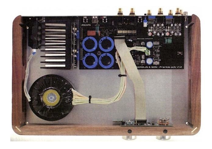
La délicate fonction du contrôle du volume a été confiée à un système passif, un réseau de résistances fixes commutées par relais donnant une échelle d'un total de 127 pas. Une solution de qualité supérieure aux potentiomètres analogiques ou numériques. De plus, elle permet un parfait équilibre entre les deux canaux sur toute l'étendue de l'atténuation et garantit la tenue des performances sur le long terme.
