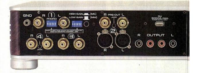
Il pannello posteriore ospita il morsetto di terra con la coppia di RCA per l'ingresso phono, due ingressi linea sbilanciati RCA, uno bilanciato XLR, un'uscita pre-out sbilanciata RCA, le prese per l'uscita di potenza sono esclusivamente progettate per ospitare connettori a banana.
