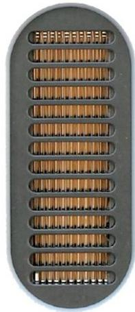
Les 770.1AMT sont la version des 770 qui intègrent le nouveau transducteur AMT réalisé par Mundorf pour Fischer & Fischer. Ce transducteur remplace le tweeter sur le coffret médium et reste encadré par deux haut-parleurs de 18 cm, mais a nécessité une révision du filtrage de l'enceinte. Ce coffret repose sur un coffret subwoofer bass reflex à deux haut-parleurs de 22 cm.
