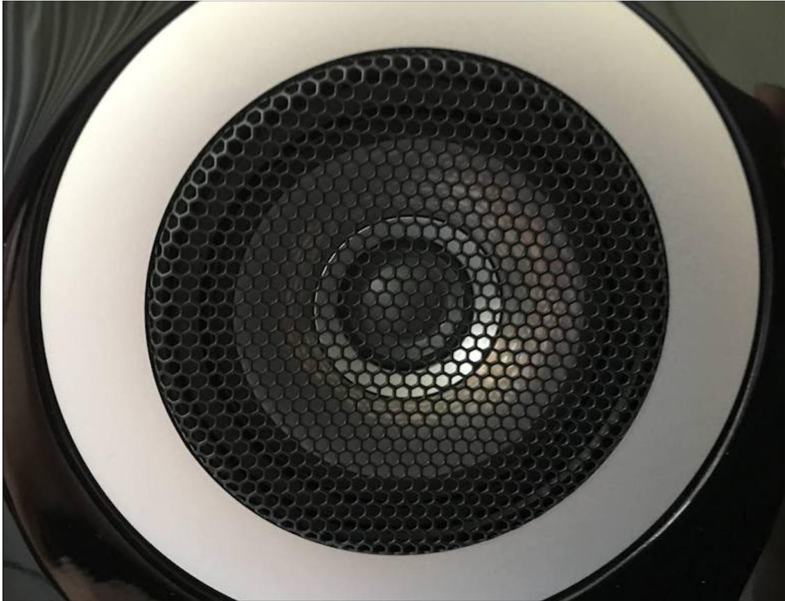
Der koaxiale Mittelhochtöner der TAD Evolution One TX CST zeichnet sich besonders durch sein extrem gleichmäßiges Abstrahlverhalten aus. (Foto: J. Schröder)
