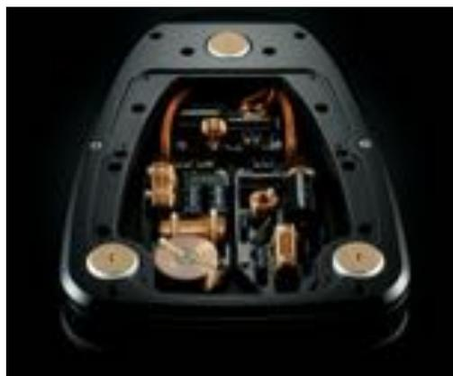
Les éléments de filtrage sont positionnés en dehors de l'enceinte, dans une base en aluminium très rigide.
