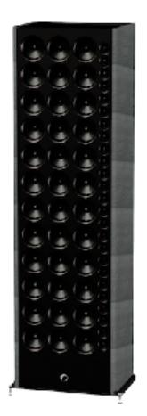
Colonne de 36 woofers et 25 tweeters Charge SRT Coffret en fibres de carbone Efficacité : 105 dB à 1W/1m Impédance nominale : 8 ohms Réponse en fréquence : 16 Hz à 20
