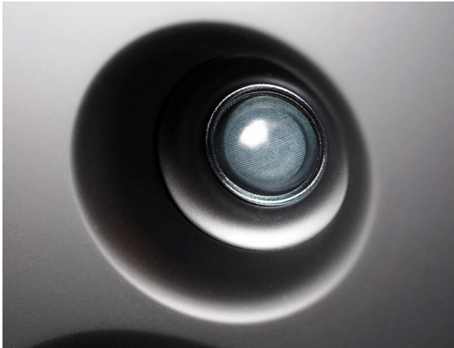
Die 25-mm-Seidenkalotte der Grandinote Mach 2R setzt erst bei 12800 Hertz ein
