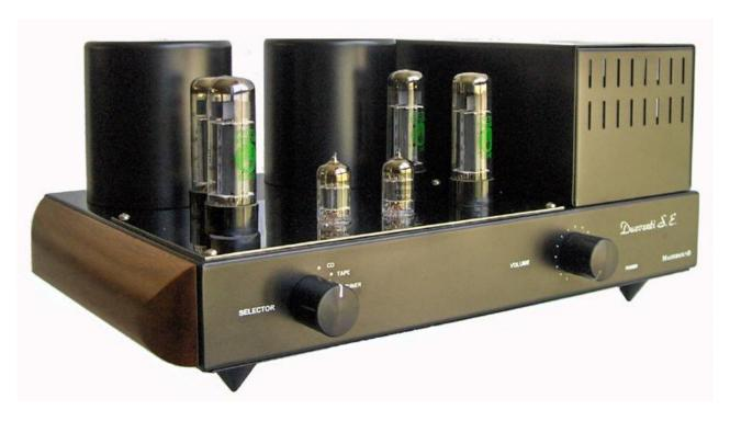
Due Venti SE est un amplificateur intégré, simple étage parallèle en pure classe A qui exploite au mieux la classique pentode EL 34. Les transformateurs de sortie que nous avons conçus et fabriqués spécialement pour ce tube permettent d'atteindre des performances inaccessibles aux transformateurs ordinaires dont le fonctionnement nécessite une contre-réaction négative.
