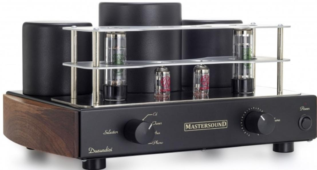
Fidèle aux principes utilisés dans tous les amplificateurs Mastersound, le Dueundici SE utilise une pentode EL 34 par canal dans l'étage de puissance en mode simple étage ultralinéaire, en classe A et sans aucune contre-réaction.
