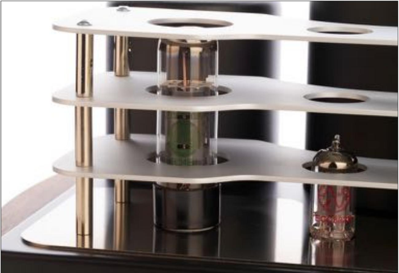
*Pro Kanal kommen eine Doppeltriode ECC802 von JJ und eine Pentode EL34 von Electro Harmonix zum Einsatz*
