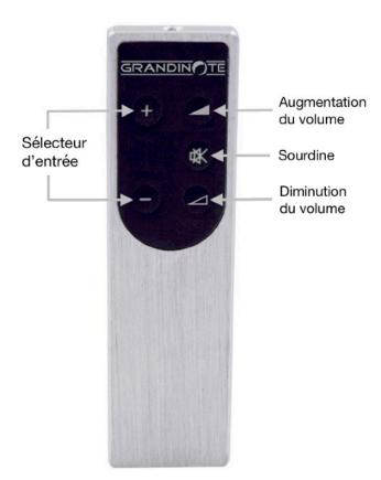
Pour remplacer la pile, appuyez avec une pointe dans le trou situé au dos de la télécommande pour faire sortir le circuit imprimé. La pile est située dans un logement connecté au circuit qu'il suffit de pousser vers le bas pour la faire sortir. La pile de remplacement de type bouton CR 2032 de 3V est à glisser dans ce logement borne + au-dessus.
