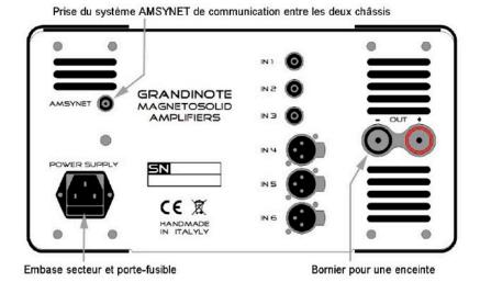
Connectez chaque source par une paire de câbles de modulation terminés par les prises adaptées au format de l'entrée utilisée, chaque câble reliant chacun des canaux droit et gauche de la source au canal correspondant de l'entrée choisie.
