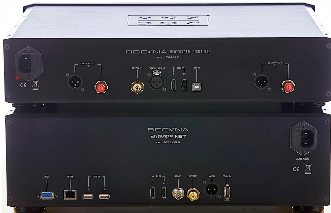
Les connexions des Wavedream Signature DAC et NET : la meilleure connexion entre les deux est l'interface I2S sur prises HDMI.
