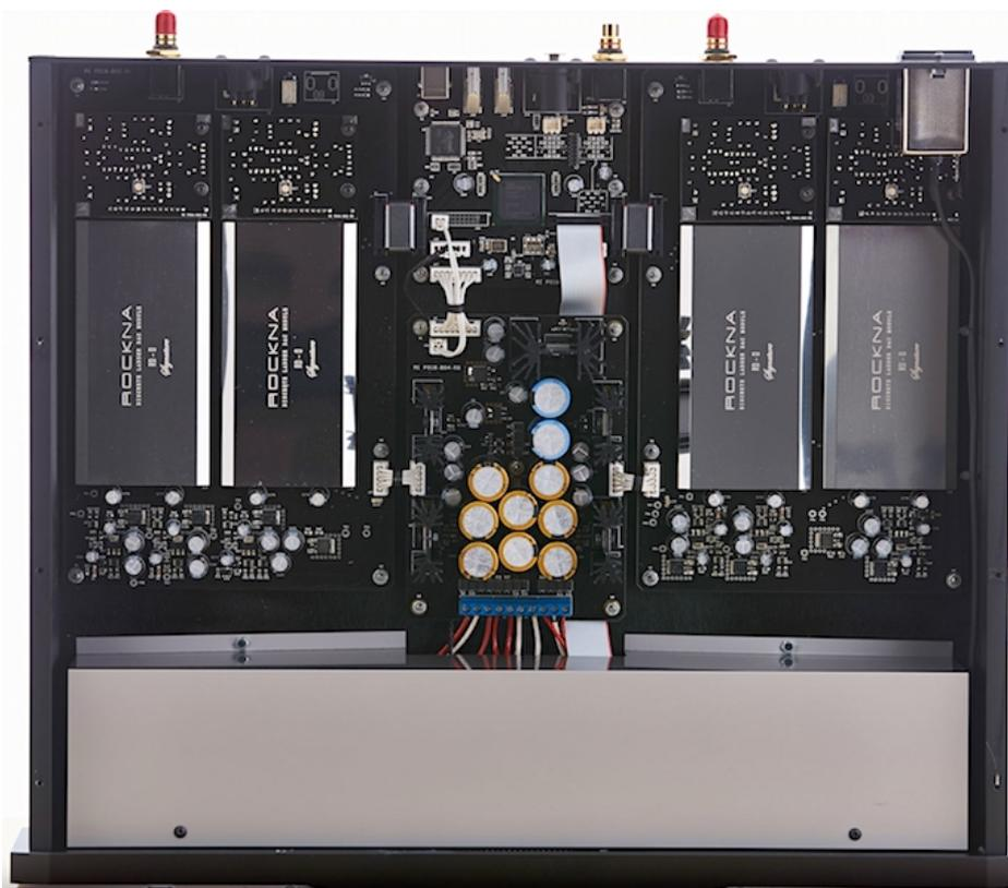
Sous le capot gris derrière le panneau frontal se trouvent les trois transformateurs pour le contrôle séparé des modules analogiques et numériques.
