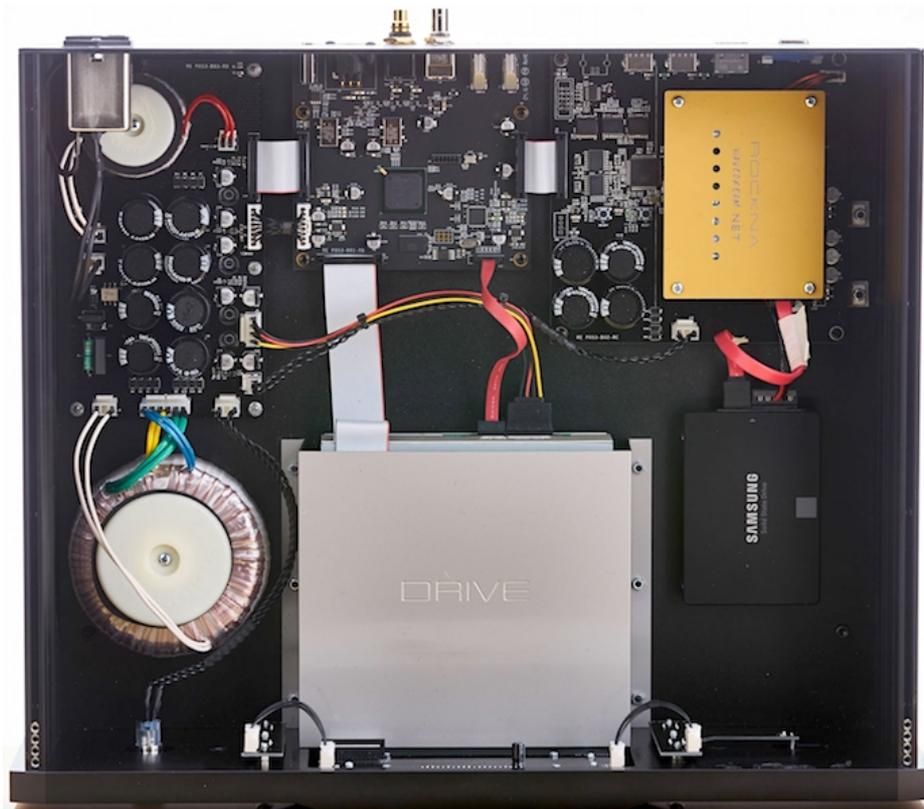
Rockna NET peut être fourni avec un DD SSD de 4 To de mémoire. A gauche, les deux alimentations analogiques. Sous le capot en haut à droite se trouve l'ordinateur avec application Roon et un processeur à quatre cœurs.
