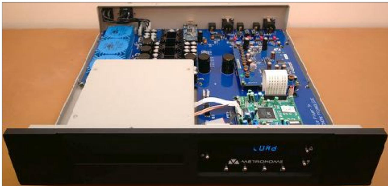
les 3 transformateurs encapsulés 1x5VA et 2x7,5 VA accompagnés d'une quarantaine de petits condensateurs. À l'évidence, la mécanique recouverte de son propre boîtier est la même que celle du transport
