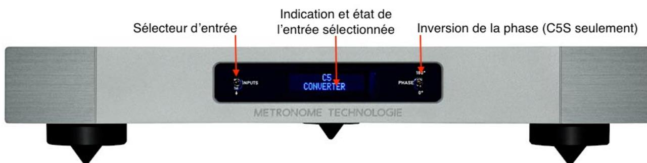
Le sélecteur d'entrée permet à chaque action sur la clé de passer d'une des 4 entrées à la suivante selon la séquence suivante : Toslink —> AES/EBU —> S/PDIF —> USB .... ou dans l'ordre inverse en agissant en sens inverse sur la clé. La dernière entrée sélectionnée avant extinction est mémorisée
