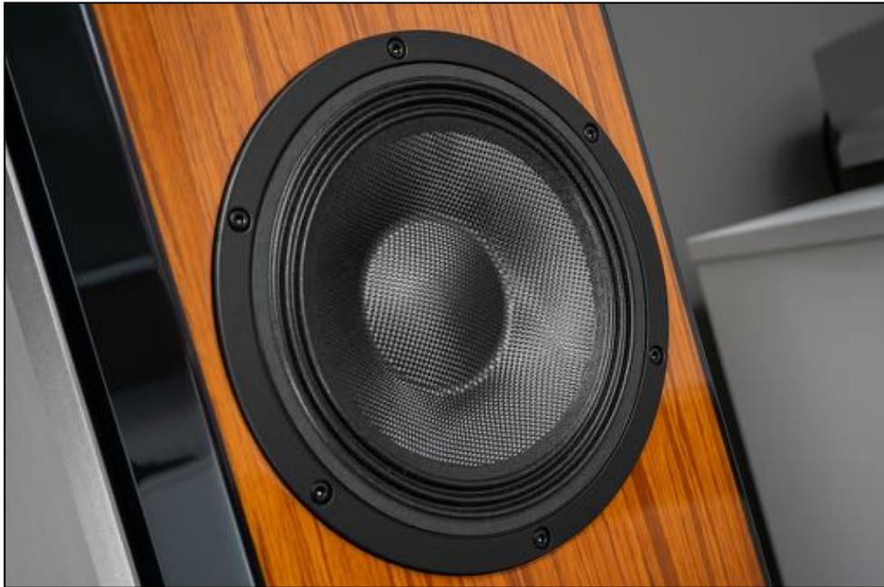
Die mehrfach gefaltete Sicke des Tieftöners fasst die Membran ein und sorgt mit ihrer Formgebung für eine definierte Führung: Sie kombiniert bestmögliche Bewegungsfreiheit für die Schwingfläche und bewirkt, im Verbund mit der Zentrierspinne, eine kontrollierte Rückführung der Membran in die Ruheposition. Um auch hier ungewünschte Vibrationen und Resonanzen zu vermeiden, ist diese Spezial-Sicke mit einer dämpfenden Beschichtung versehen.
