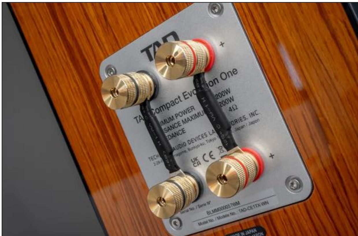
Das Terminal des CE1TX bietet auf einer fünf Millimeter starken Aluminium-Platte vier großdimensionierte Anschlussklemmen aus massivem Messing. Dank der großen Aufnahmen lassen sich auch querschnittstarke Litzen verwenden. Die gewichtigen Klemmen sind herrlich geschmeidig drehbar und können dank der guten Griffigkeit leicht angezogen werden. Mit ihrer massiven Ausführung halten sie sicher auch sehr dicke und schwere Kabel.
