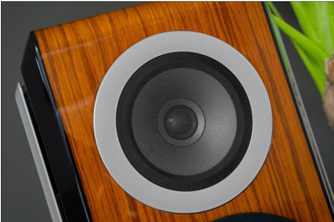
Der Koaxial-Treiber für Mitten und Höhen ist von einem matten Aluminiumring eingefasst und durch ein feinmaschiges Metallgitter geschützt. Das kommt dem empfindlichen Beryllium-Tweeter zugute, der im Zentrum des Mitteltöner-Konus sitzt. Zusammen bewirkt dieses koaxiale Duo eine punktschallquellenartige Abstrahlung, die überaus räumlich, homogen und natürlich ist.
