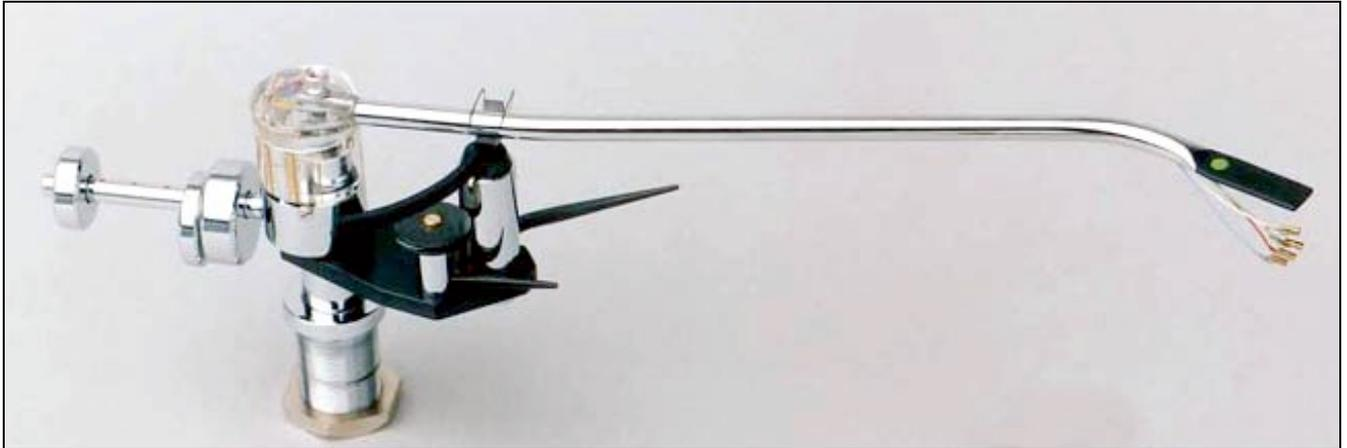
Le modèle UP-4 intègre une conception particulière du principe unipivot. Le roulement consiste en une pointe en acier très dur reposant sur un saphir concave et poli. Ce roulement est amorti dans toutes les directions de mouvement par un fluide de silicone. La position basse du roulement produit une meilleure stabilité en comparaison des autres bras unipivots par le fait qu'une grande partie de la masse mobile du bras est située au-dessus du point de l'unipivot.
