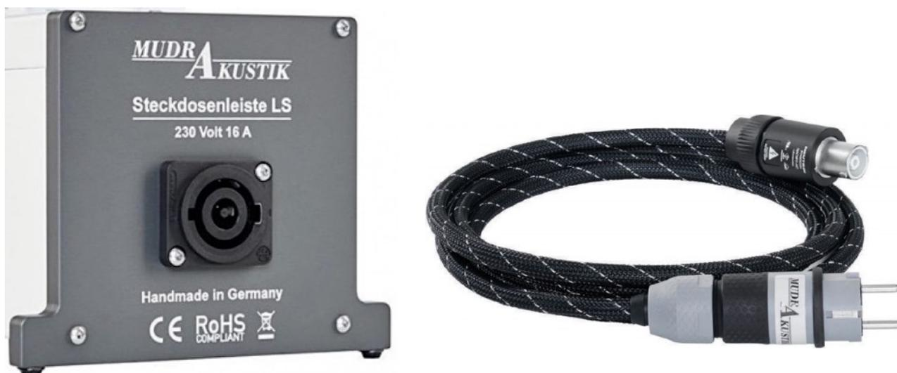
La fiche mâle du cordon s'insère dans l'embase de la barrette en respectant la position imposée par les guides. Son verrouillage est obtenu en la tournant légèrement en sens anti-horaire et confirmé par un déclic audible. Pour déconnecter la prise, ramenez le poussoir en arrière et tournez la prise dans le sens horaire pour pouvoir la dégager de son embase.
