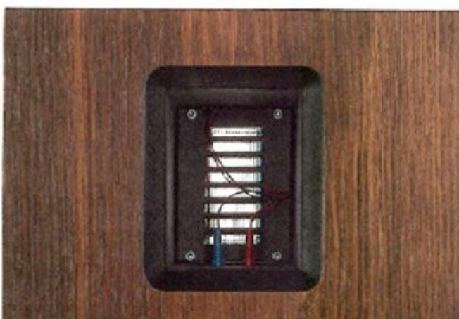
Ein schöner Rücken: Der AMT strahlt den Schall nach vorn wie nach hinten ab
