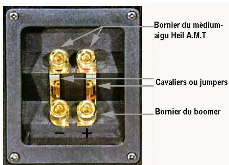
**En simple câblage** : avec une paire de câbles de qualité, connectez les bornes de sortie + (rouge) et - (noir ou blanc) de chaque canal de l'amplificateur respectivement aux bornes + (rouge) et - (noir) situées à l'arrière de l'enceinte correspondante à ce canal.
