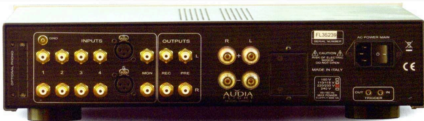
Une connectique de qualité, et des possibilités d'évolution grâce à des modules enfichables (voir la petite trappe à droite).
