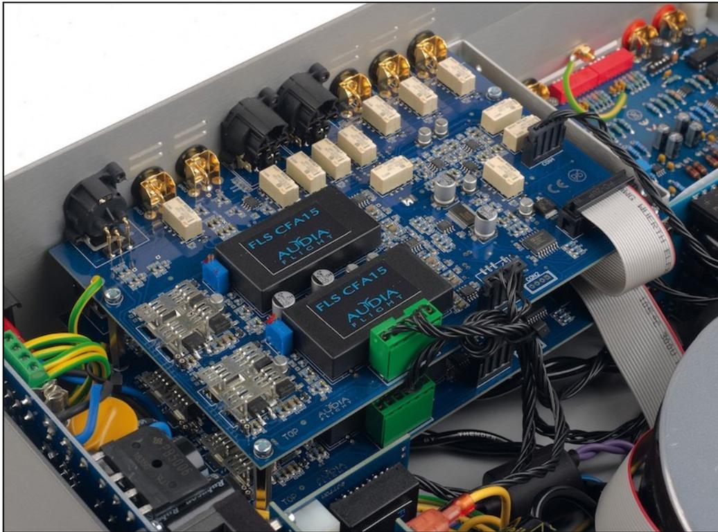
*La section préamplificatrice avec les modules partiellement enrobés se trouve directement aux entrées. À partir de là, le traitement du signal est exclusivement en mode symétrique. Sur la droite : la carte phono.*
