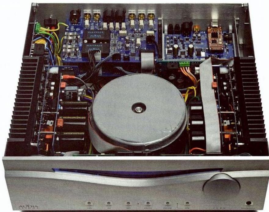
À l'intérieur, le gigantesque torique blindé prend ses aises ; de part et d'autre se trouvent les blocs de puissance. Au fond, les entrées à commutation par relais et les modules de pré-amplification FLS CFA15. À droite, les 2 baies prises par la carte DAC et le phono au dessous. À l'arrière, les entrées RCA sont doublées XLR. Les borniers isolés acceptent toutes les terminaisons : banane, fourche ou câble nu.
