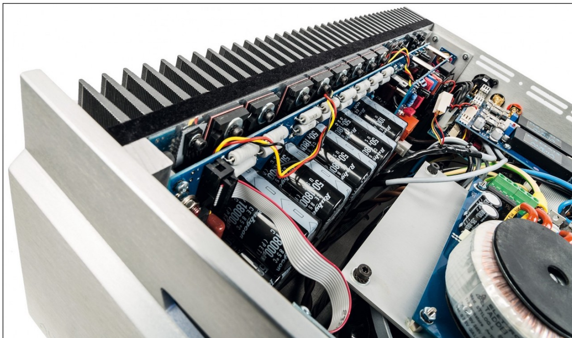
Étage de puissance d'une des voies
