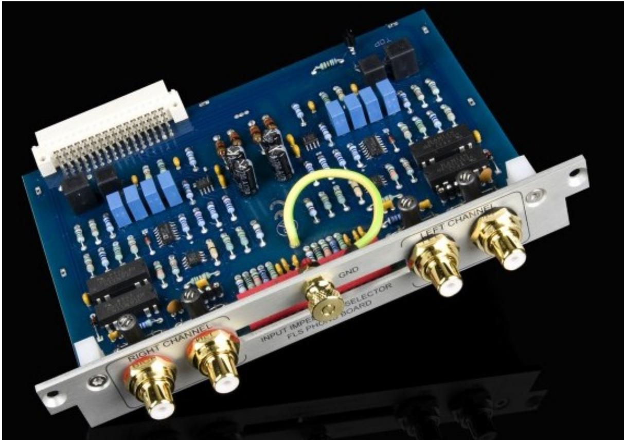
La carte FLS Phono offre deux entrées : une entrée MM (aimant mobile) et une entrée MC (bobine mobile). Les deux entrées peuvent être utilisées indépendamment l'une de l'autre ; il est donc possible de connecter simultanément une cellule MM et une cellule MC.
