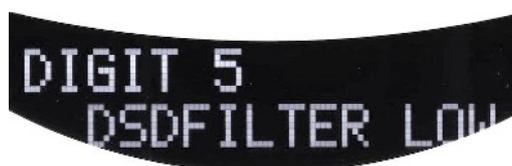
**LOW** (filtrage à 39 kHz, pente douce) ou **HIGH** (filtrage à 76 kHz, pente raide) est sélectionné par + ou – et clignote pour être validé sans action pendant quelques secondes puis retour à l'écran initial.
