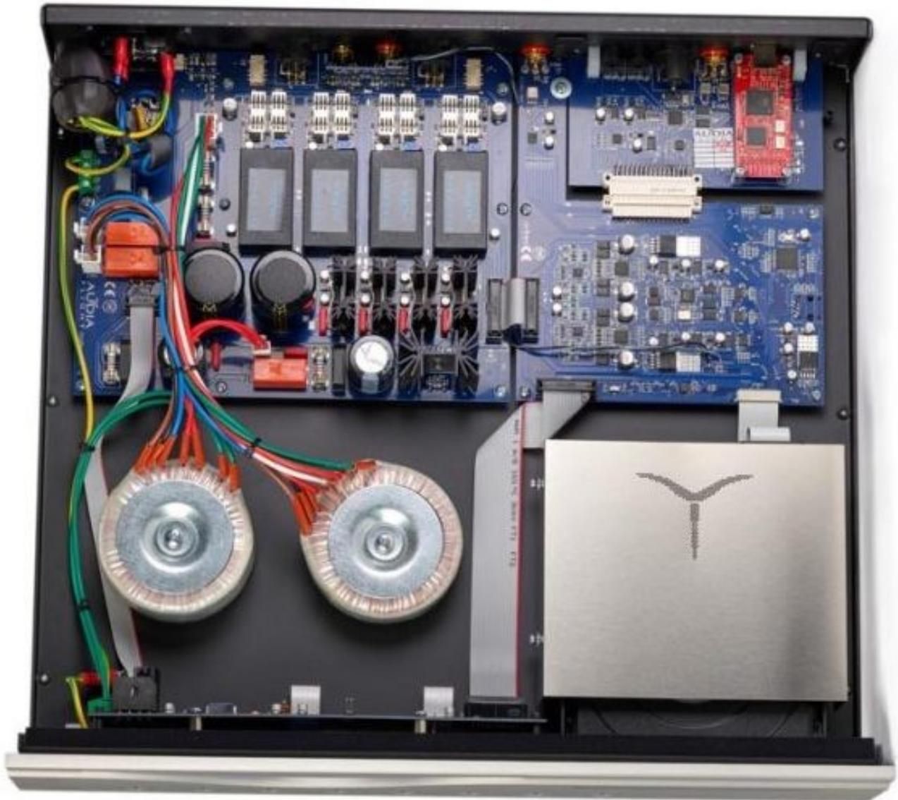
*Suchbild mit Kabelbrücken: Der CD-Spieler versteht sich in (beinahe) perfekter Diskretion. Gekapseltes Laufwerk, Steuerungsplatine, separates DAC-Board und die riesige analoge Signalverarbeitung, die sich eine Platine mit der Spannungsaufbereitung teilt.*
