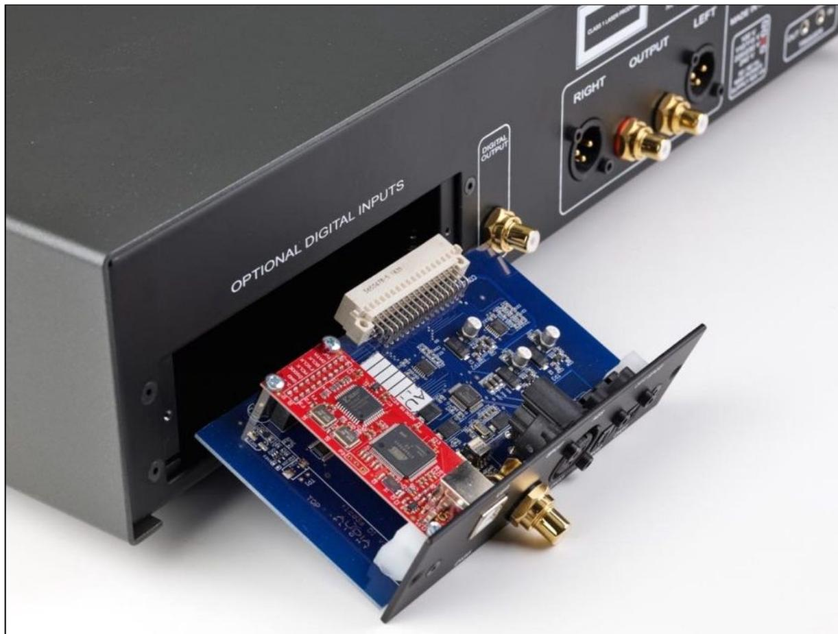
*Der Wandler sitzt auf einem separaten Einschub. Die verschachtelte Platine wandelt Signale bis 32/384 (via USB) und bietet eine digitale Pegelsteuerung.*
