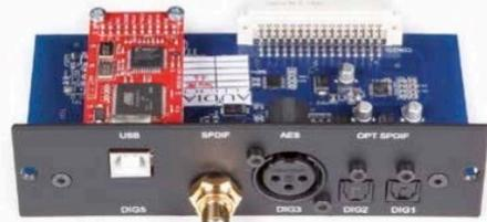
La carte numérique optionnelle, coûtant 360 euros, prend place dans un logement accessible en face arrière après avoir enlevé la trappe qui obture l'entrée. La carte s'enfile sur des guides latéraux et se verrouille par le connecteur du fond puis les vis de façade.
