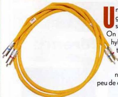
Un peu plus complexe que The Valley, The Rock comporte un conducteur de gros diamètre associé à onze brins de cuivre pur placés autour de lui. Cette structure devrait permettre de réduire l'inductance à son niveau le plus faible. On retrouve la technique 3T et le principe LSC : une couche de matériau hybride améliorant l'isolation. Le blindage proprement dit est assuré par deux tresses de cuivre épaisses.
