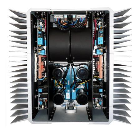
Il y a deux alimentations distinctes pour chaque canal : l'une, stabilisée pour toutes les parties de pilotage, l'autre fournissant l'énergie à la partie de puissance proprement dite.
