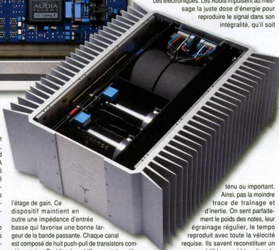
l'étage de gain. Ce dispositif maintient en outre une impédance d'entrée basse qui favorise une bonne largeur de la bande passante. Chaque canal est composé de huit push-pull de transistors complémentaires Toshiba. Les chiffres sont donc éloquentes : un courant de 160 ampères en crêtes, et une puissance en pure classe A de 100 watts sous 8 ohms, 200 sous 4 et 400 sous 2 !
