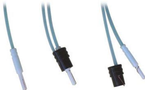
Stratos est un câble à conducteur monobrin de cuivre OFC, isolé par une gaine épaisse mais souple et légère. Il existe en deux versions : le Stratos 0.4 dont le conducteur a un diamètre de 0,4 mm, destiné à la confection des câbles de modulation et le Stratos 0.6 d'un diamètre de 0,65 mm pouvant aussi être utilisé en câbles d'enceintes.
